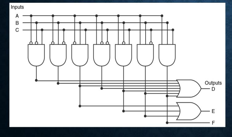
• So, our products (or minterms) are:  $T1 = A \cdot \overline{B} \cdot \overline{C}$   $T2 = \overline{A} \cdot B \cdot \overline{C}$   $T3 = \overline{A} \cdot \overline{B} \cdot C$   $T4 = A \cdot B \cdot \overline{C}$   $T5 = A \cdot \overline{B} \cdot C$   $T6 = \overline{A} \cdot B \cdot C$
